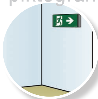
Riktningssändring i utrymningsväg
