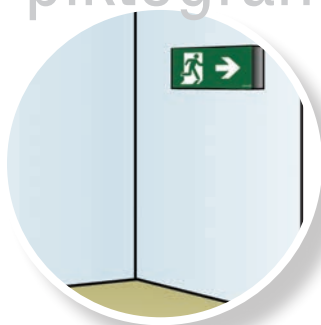
Riktningssändring i utrymningsväg
