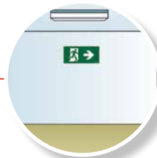
Skylltning av utrymningsväg
