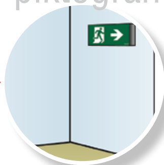
Riktningssändring i utrymningsväg
